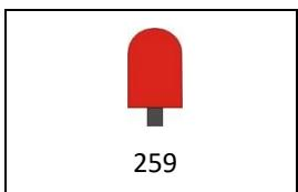
En plus du signal selon image 259, le signal limite de garage peut aussi consister en un clou rouge planté dans le bitume.
